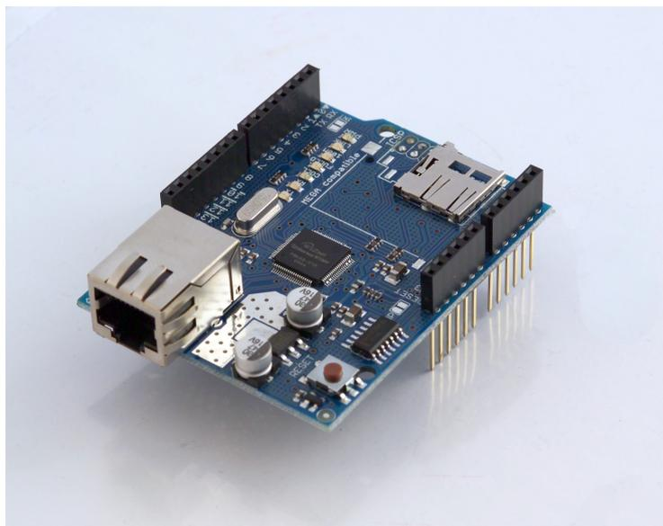
Figura 2.7: *Shield Ethernet para placa Arduino. Se observa la clavija RJ45 propia de Ethernet y un lector de tarjetas SD. La disposición de los pines aparece inalterada con respecto a la placa original.*
