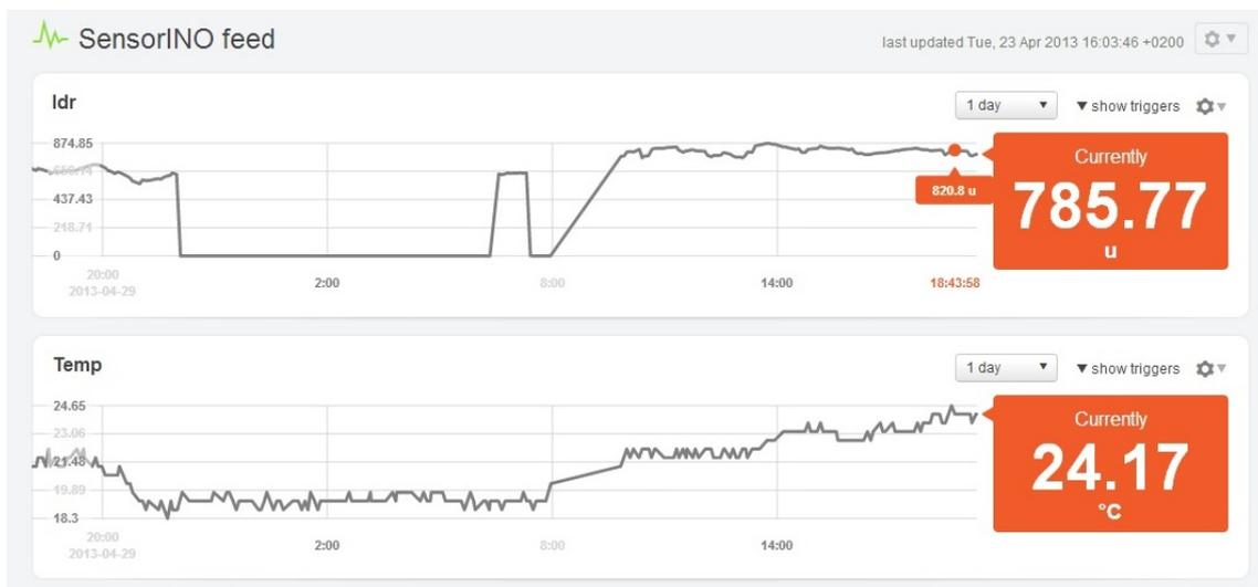
Figura 4.3: Visualización de la gráfica en un intervalo de 1 día. El valor bajo de la luminosidad corresponde a la noche, también se aprecia la bajada de temperatura que ocurre por las noches
