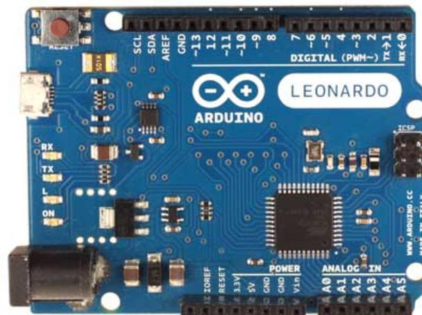
Figura 3.7: Placa Arduino Leonardo Oficial. Se pueden observar los distintos pines así como el microcontrolador ATmega32u4.
