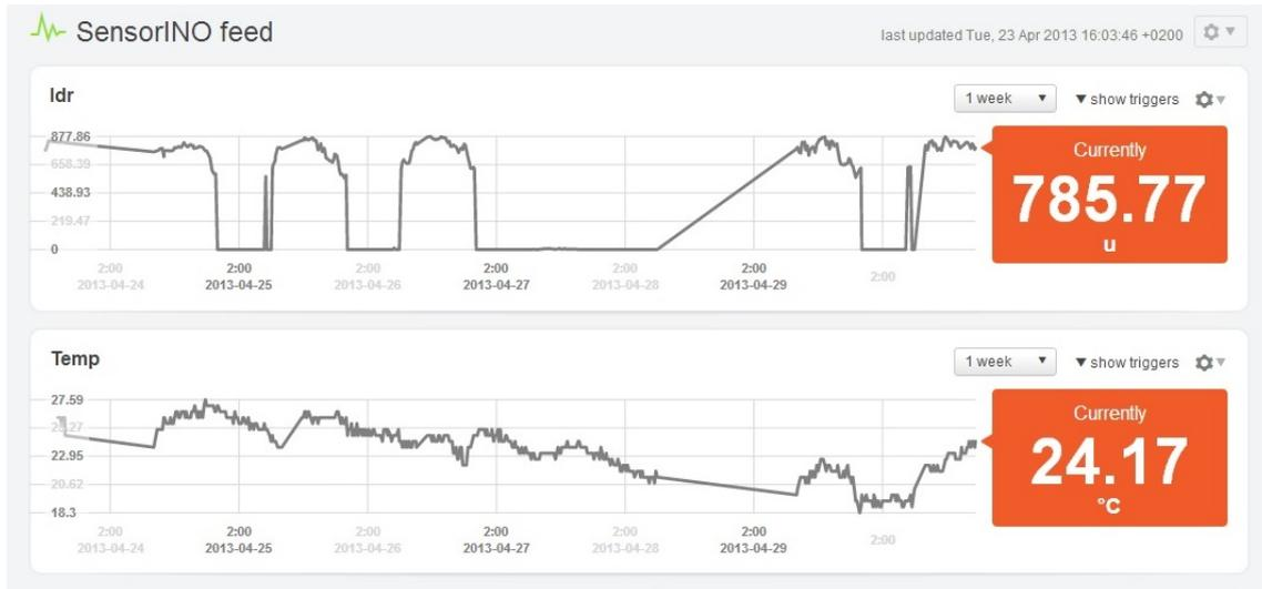
Figura 4.4: Visualización de la gráfica en un intervalo de 1 semana. Se aprecian claramente los días y las noches debido al sensor LDR. Además, la temperatura durante esa semana fue bajando, hecho constatable con las medidas del sensor de temperatura. La aparición de zonas con líneas muy rectas indican cuando la máquina fue reiniciada automáticamente y no pudo reanudarse hasta tiempo después
