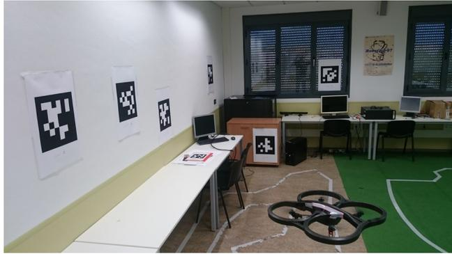
Primero, el driver *ArDroneServer* da soporte al ArDrone2.0 de Parrot, que se ha usado principalmente como juguete y en interiores. Este cuadricóptero tiene dos cámaras, una frontal y otra cenital. El driver permite a las aplicaciones cambiar explícitamente entre una u otra.
