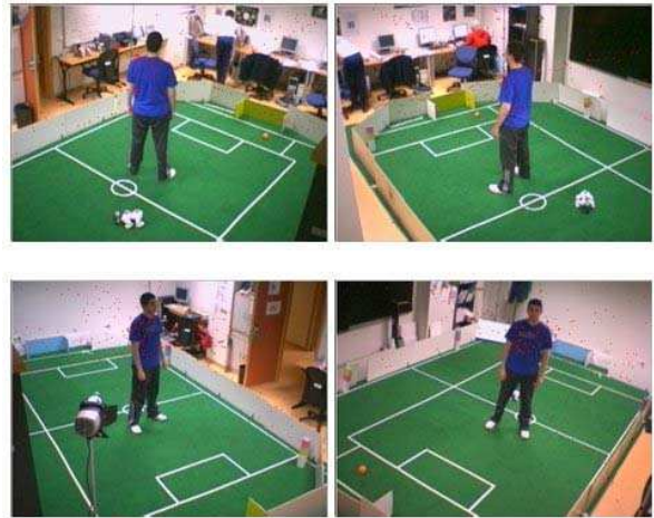
Figura 4: Ejemplo de seguimiento 3D con 4 cámaras
