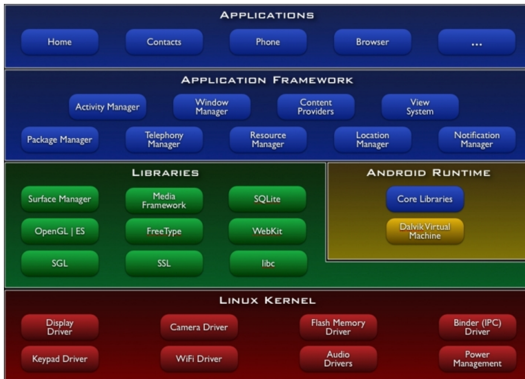
Figura 1.6: Diagrama de la arquitectura del sistema Android.
