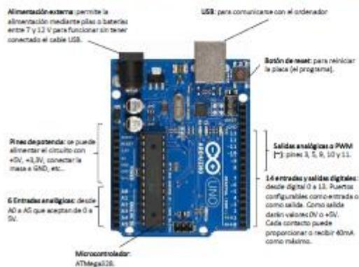
**Sensores analógicos:** proporcionan una variación de voltaje dependiendo de lo que varíe la magnitud física medida. Se deben conectar a las entradas analógicas, que traducirán los valores de tensión continua que les llegue entre 0 y 5V a valores digitales entre 0-1023. Un ejemplo de sensor analógico es el sensor de temperatura LM35.
