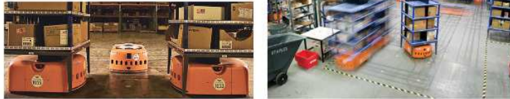
Figura 7: Robots de Kiva Systems (izquierda) e instalaciones en Denver (derecha) donde los robots realizan trabajos de almacén
