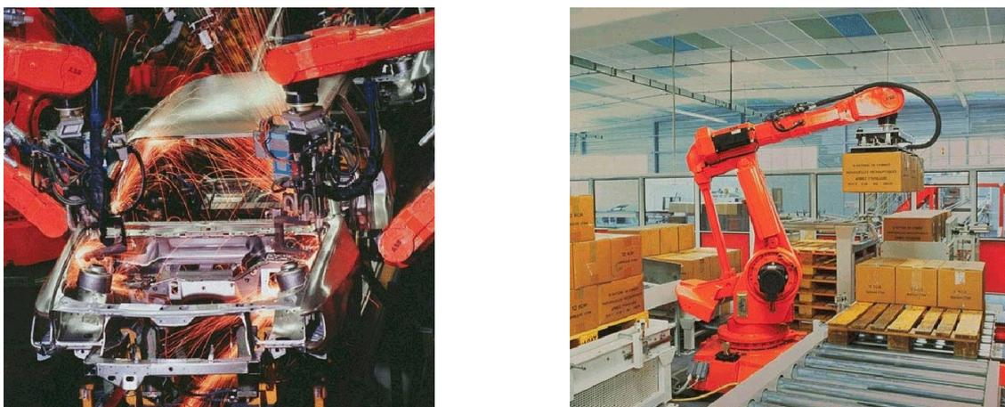
**Figura 1.1:** Robots soldadores en una factoría de coches (izda.) y brazo transportando materiales (dcha.)
