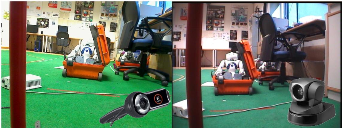
Figura 3.3: A la izquierda, imagen tomada con la webcam *Logitech Quickcam Pro 9000*; A la derecha, imagen tomada con la *Sony EVI-D100P*. En la izquierda de las imágenes se puede apreciar la distorsión introducida por la cámara en un palo recto.
