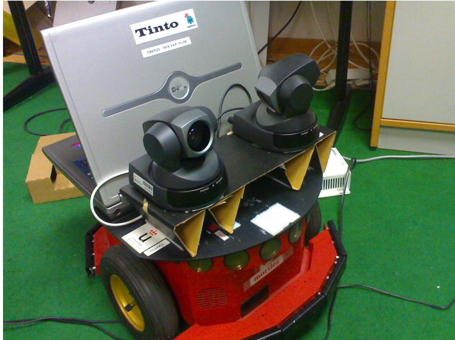
Figura 3.1: El robot con las cámaras montadas.
