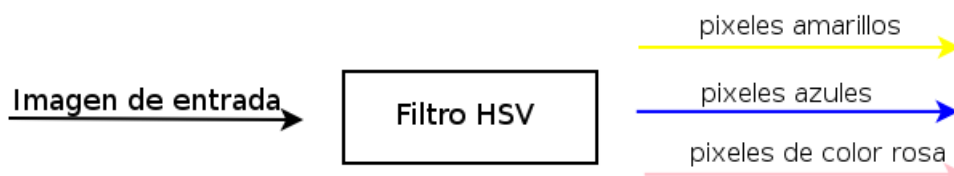
Figura 5.12: Entrada/Salida del filtro HSV
