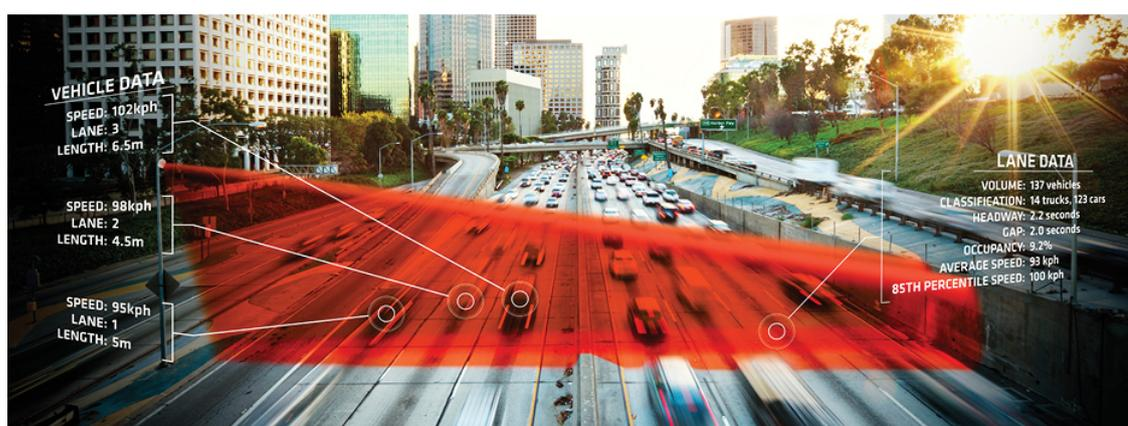
Figura 1.14: Dispositivo basado en radar que recoge diversa información del tráfico en tiempo real
