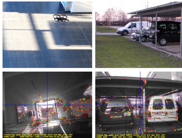
Figura 1.11: Sistema de navegación de un drone autónomo
