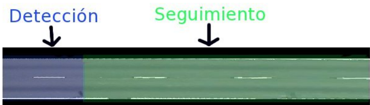
Figura 4.3: Zona de detección y seguimiento en la carretera
