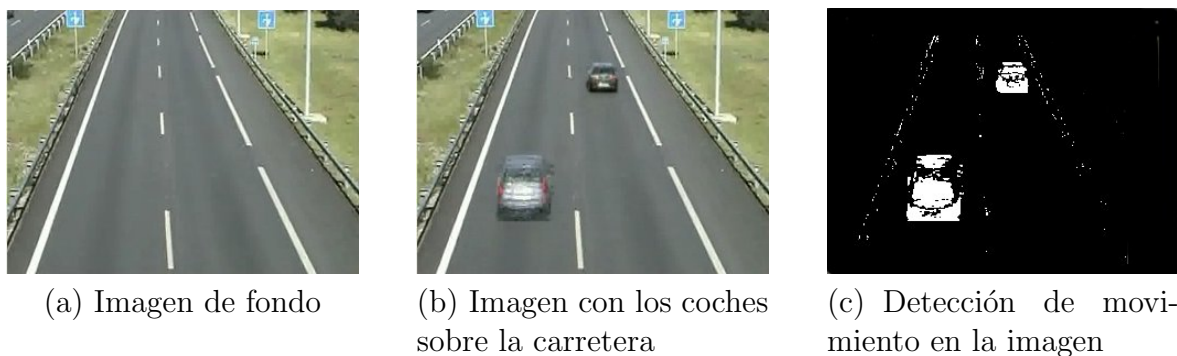
Figura 4.9: Detección de movimiento para el cálculo de la función salud
