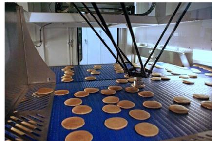
(b) Robot ABB de envasado automático
