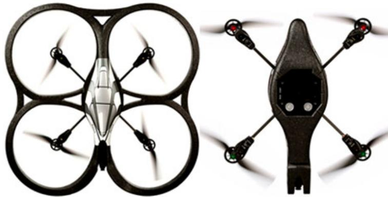
Figura 1.6: ArDrone en modo interiores (izq) y en modo exteriores (dcha). Los rotores de la parte superior de la imagen corresponden a los frontales.
