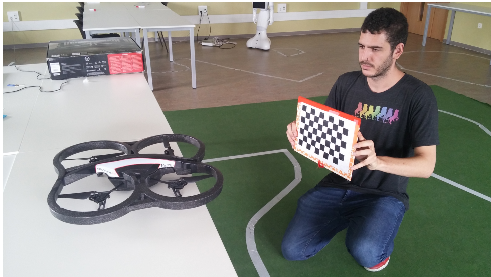
Figura 5.13: Proceso de calibración del drone real
