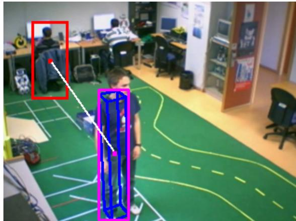
Figura 5.11: Distancia entre un ROI de movimiento y la envolvente del representante de una raza en una imagen.
