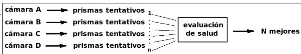
Figura 5.3: Esquema del algoritmo de seguimiento 3D.
