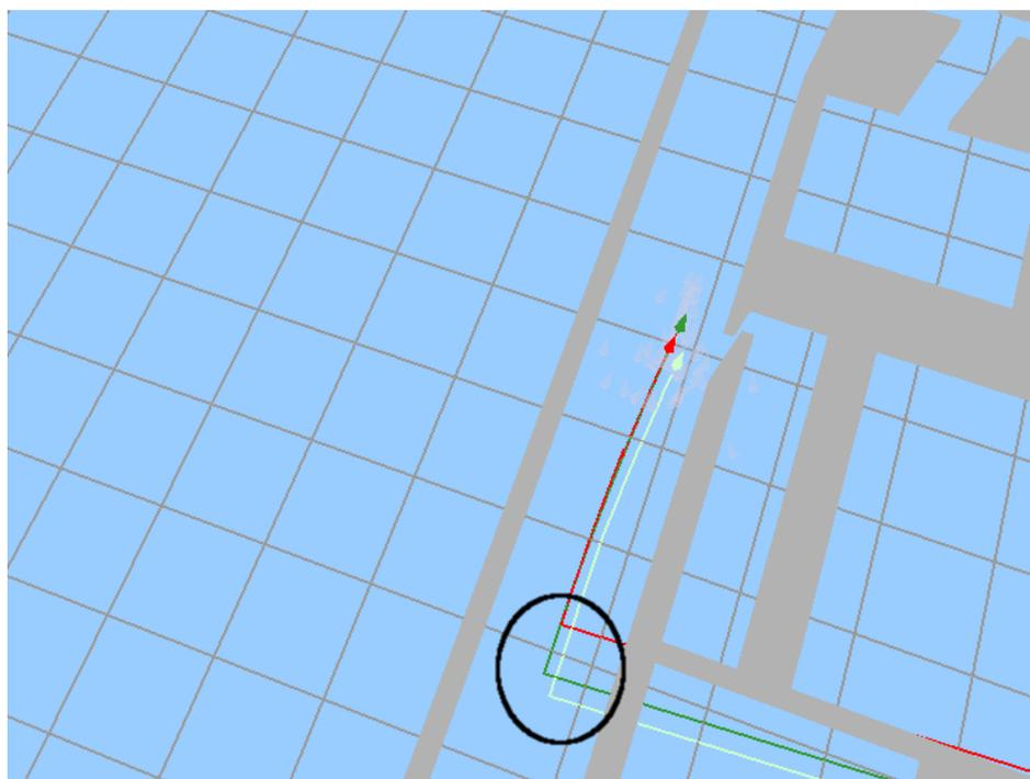
Figura 5.14: Robustez ante secuestro: relocalización tras desplazamiento. Se muestran los saltos en los recorridos producto del desconocimiento del *secuestro* por parte del robot y algoritmo. Marcado en círculo se destaca el recorrido efectuado por el robot antes de que el algoritmo emitiese como posición estimada de nuevo la cercana a la verdadera.
