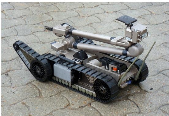
Figura 1.4: Robot multipropósito militar PackBot
