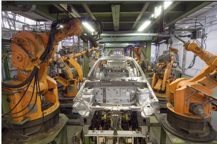
Figura 1.1: Ejemplo de robot industrial de ensamblaje automotriz. [1]
