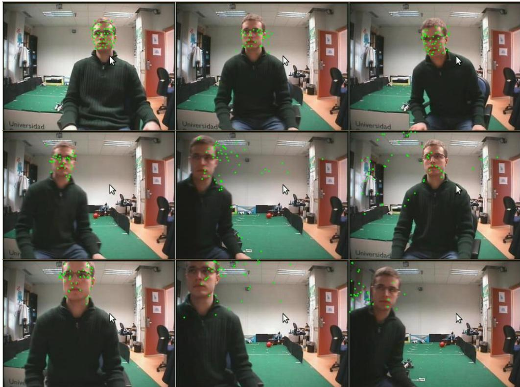
Figura 5.4: Seguimiento basado en flujo óptico.
