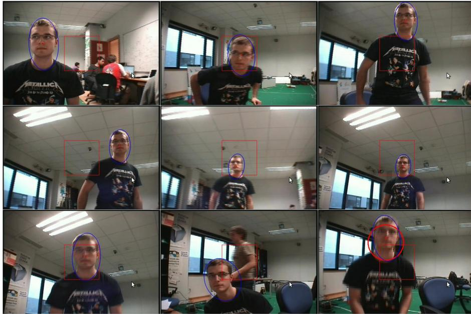
Figura 5.24: Capturas de la cámara EVI D100P mientras sigue una cara apoyándose en el filtro de verosimilitud de color y Camshift.
