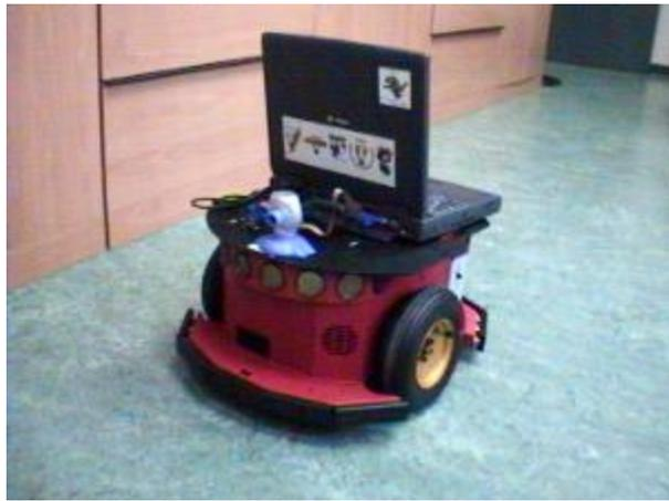
Figura 1.4: Robot Pioneer con PC portátil y cámara para visión
