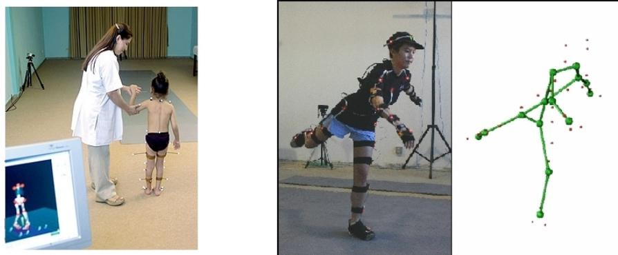
Figura 1.3: Un laboratorio de análisis de marcha y un ejemplo de proceso de captura de movimiento.
