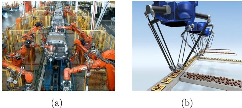
**Figura 1.1:** (a) Robot integrante de una cadena de montaje de automóviles (b) AdeptQuattro realizando tareas de envasado
