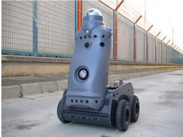
Figura 1.7: *mSecurit* robot móvil de vigilancia
