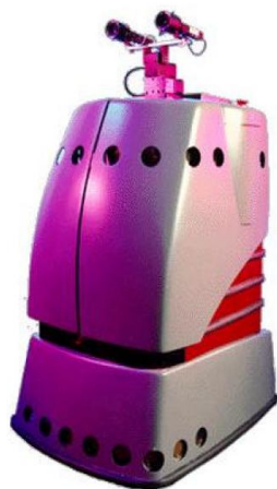
Figura 1.5: Robot MINERVA para guiado autónomo de visitantes a museos.
