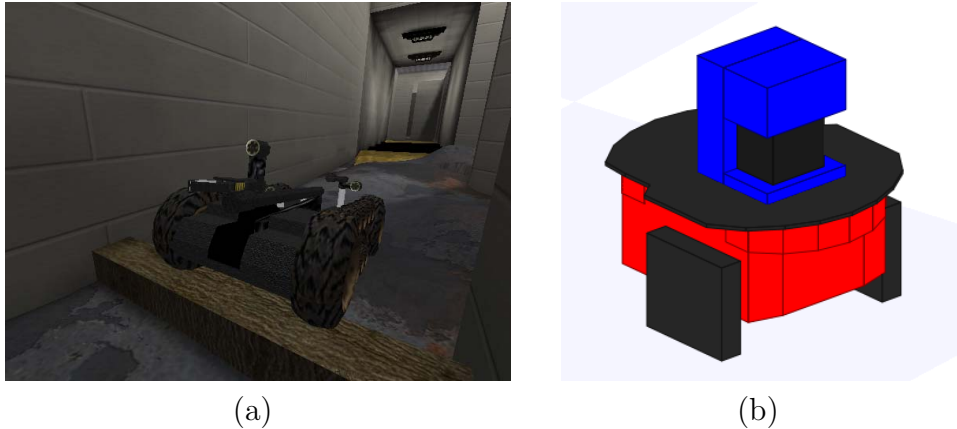
Figura 1.6: Simulación con USARSim(a). Robot Pioneer simulado con Stage(b)
