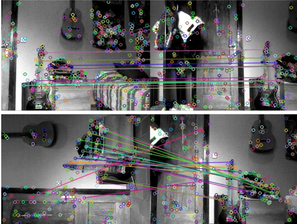
FIGURA 5.4: Captura de los emparejamientos con imágenes sometidas a una traslación y a una rotación, respectivamente.
