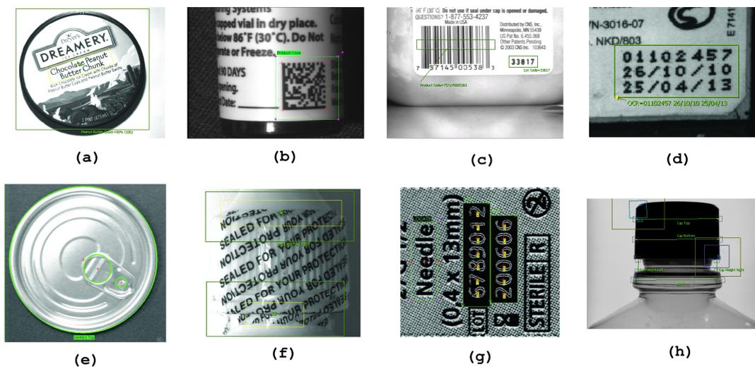
FIGURA 1.3: Presencia, aplicación e integridad de etiquetas (a), códigos 2D (b), códigos de barras (c), validación de lote, fecha y código (d), orientación de piezas montadas (e), correcto sellado (f), calidad de impresión (g), presencia y cierre de tapones (h).
