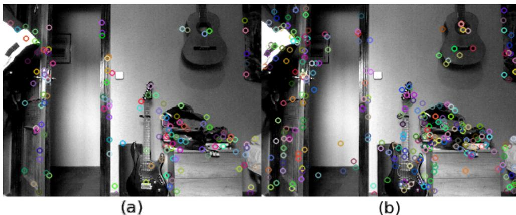
FIGURA 5.2: Captura de la extracción de puntos de interés con filtro frontera (a), y sin filtro (b).
