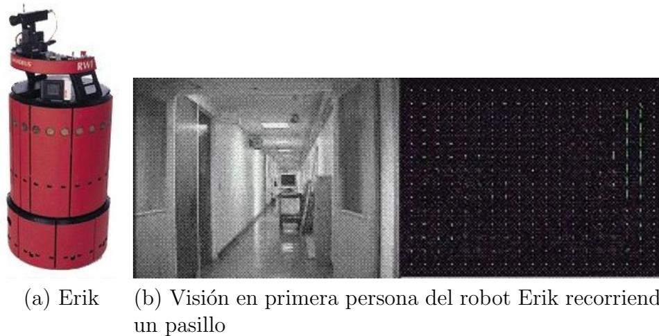
Figura 1.7: Robot Erik del MIT, capaz de navegar utilizando flujo óptico
