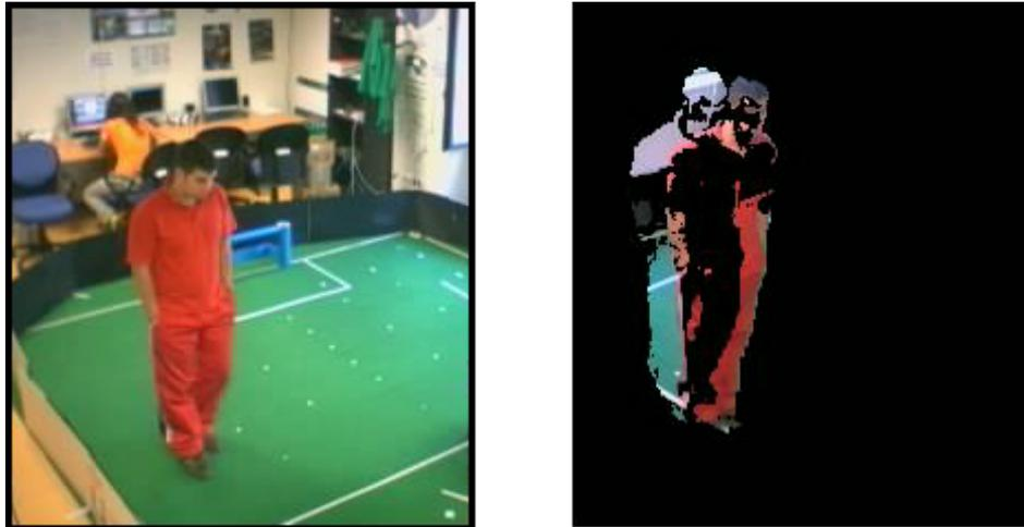
Figura 1.6: Búsqueda del movimiento mediante el método de las diferencias
