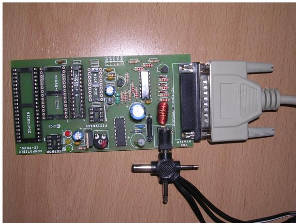
Figura 4.4: Detalle del programador empleado en el proyecto SIA
