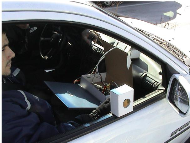
Figura 6.9: Montaje del sistema sensorial para exteriores.
