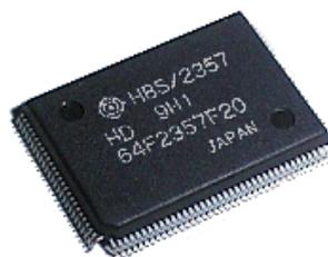
Figura 4.3: Ejemplo de microcontrolador Hitachi H8
