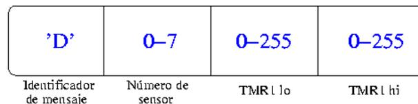
Figura 5.5: Formato del mensaje enviado al PC en caso de recepción de ECHO
