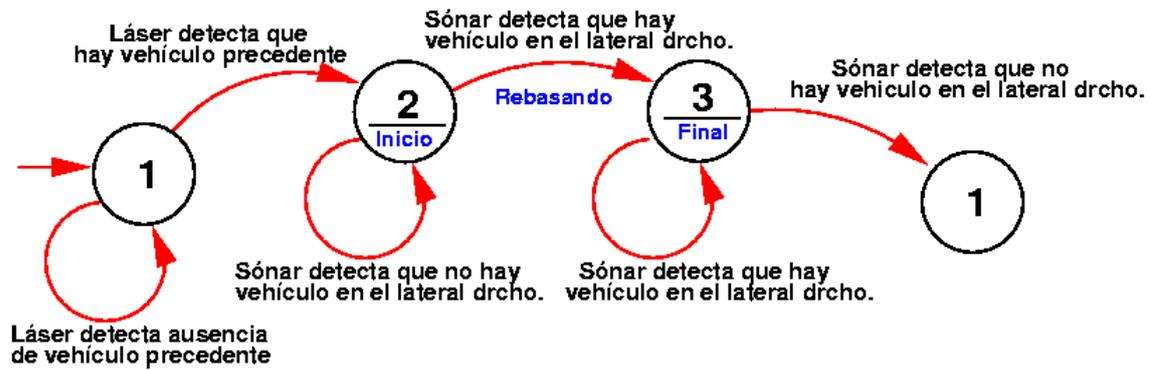
Figura 5.14: Diagrama de flujo del autómata empleado en la aplicación de control
