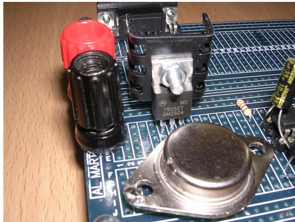
Figura 4.7: Detalle de los reguladores y bornas de alimentación
