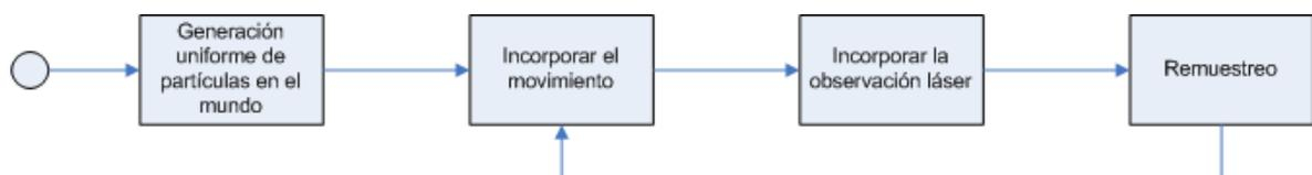
Figura 4.12: Diagrama de flujo del localizador con filtro de partículas.
