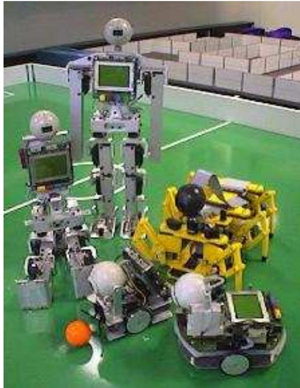
Figura 2.5: Ejemplos de robots con la misma RoBIOS y distinta HDT
