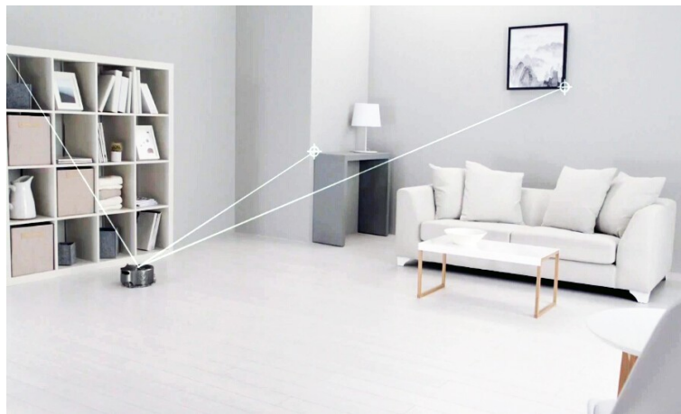
Figura 1.4: Aspiradora Dyson utilizando autolocalización visual
