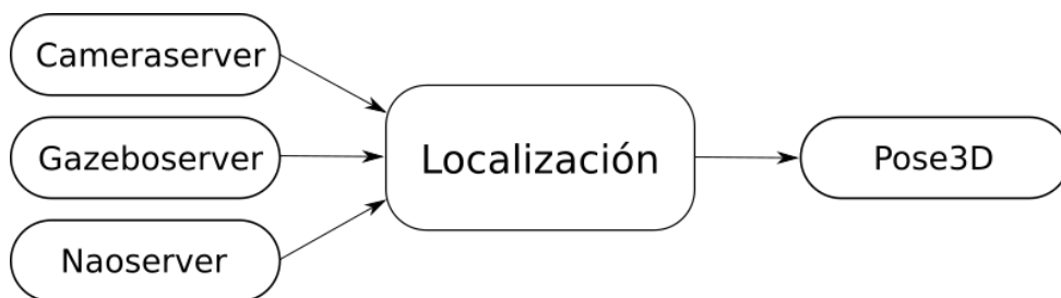
Figura 3.12: Conexiones del componente de localización en JdeRobot.
