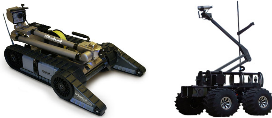
Figura 1.7: Robot PackBot (izquierda) y robot MARCbot (derecha) utilizados en conflictos armados reales
