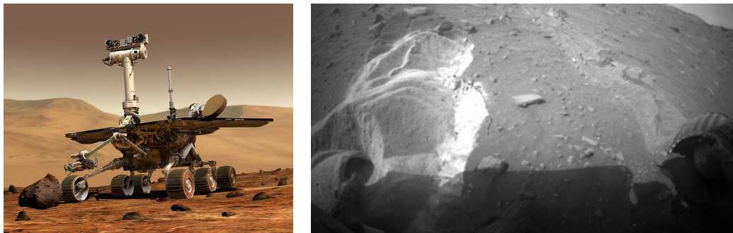
Figura 1.8: Robot Spirit (izquierda) e imagen real tomada en una situación complicada de atasco en la arena de Marte (derecha)
