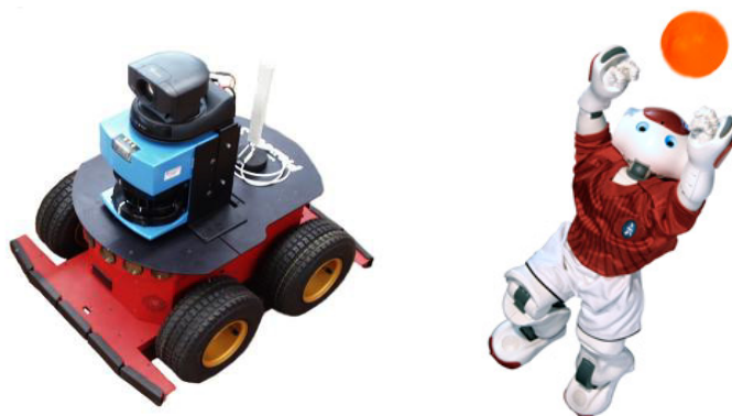
Figura 1.10: Robot Pioneer equipado con un sensor láser y una cámara motorizada (izquierda) y robot Nao promocionando la competición RoboCup 2009 (derecha)
