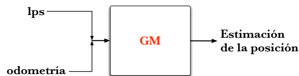
Figura A.2: Entradas y salidas del módulo GM
