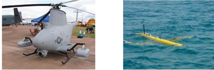
Figura 1.2: UAV MQ-8B Fire Scout (izquierda) y UV Bluefin-12(derecha).
