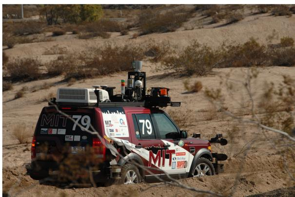
Figura 1.10: Vehículo autónomo usado en el *Grand Challenge*.
