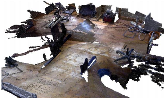
Figura 1.10: Reconstrucción usando RGB-D SLAM.
