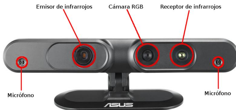
Figura 3.1: Partes del dispositivo Asus Xtion PRO LIVE.
