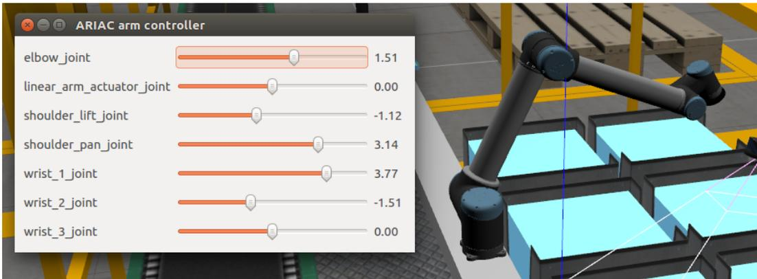
Figura 5.8: Interfaz gráfica del controlador del brazo y brazo en la posición inicial.
