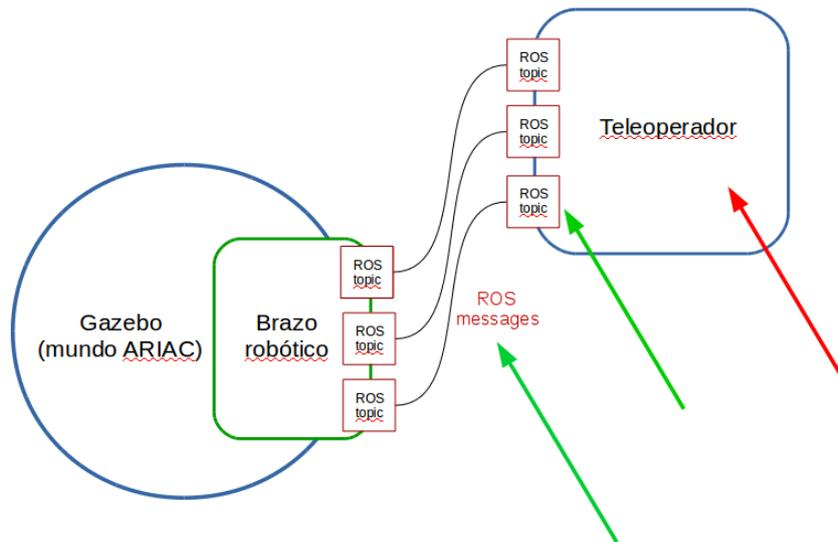
Figura 5.4: Esquema de los componentes de ARIAC centrándonos en el brazo.
