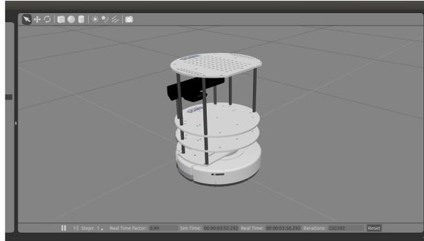
Figura 1.5: Robot kobuki en Gazebo.
