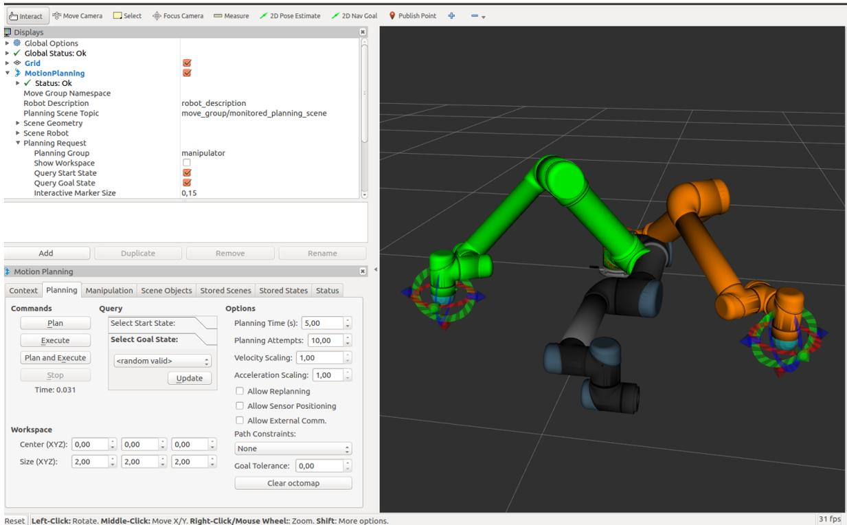
Figura 5.11: Herramienta rViz mostrando la trayectoria del brazo.
