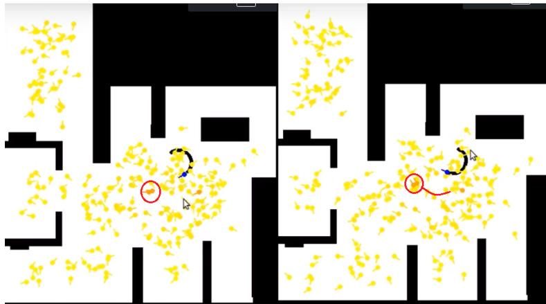
Figura 5.18: Incorporación relativa de odometría
