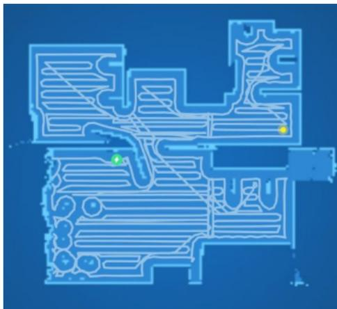
Figura 5.8: Patrón de navegación de la aspiradora Xiaomi
