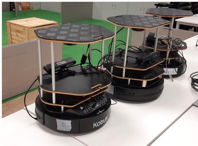
Figura 1.11: Robots Turtlebot2 del laboratorio de robótica
