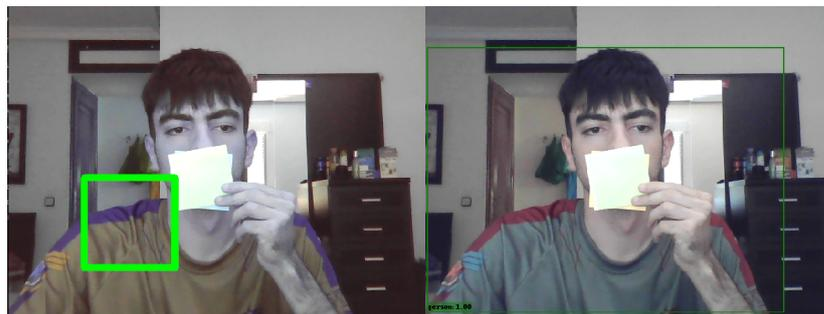
Figura 5.3: Diferencia de precisión de YOLO y OpenCV
