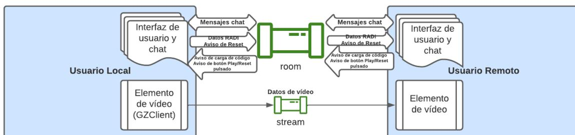
Figura 5.5: Diagrama de conexión WebRTC establecida con una conexión multimedia y un `DataChannel`.
