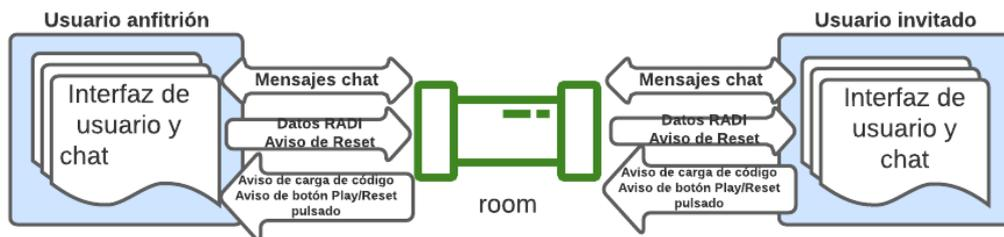
Figura 5.4: Diagrama de transmisión de datos entre plantillas.
