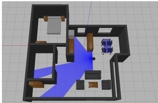
Figura 3.8: Autolocalización de robots.
