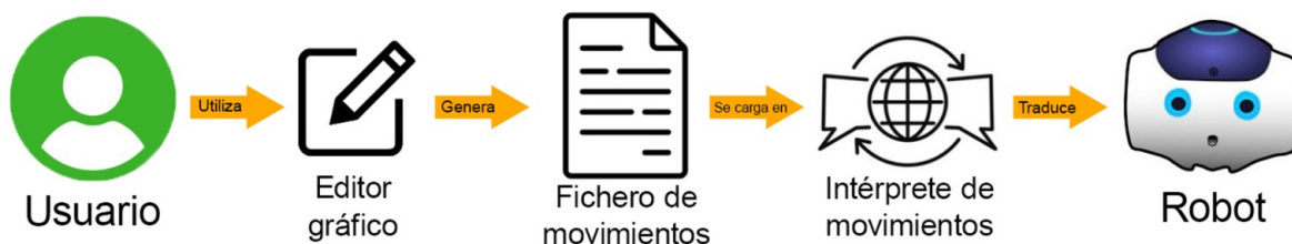
Figura 4.6: Esquema del funcionamiento del editor y el intérprete
