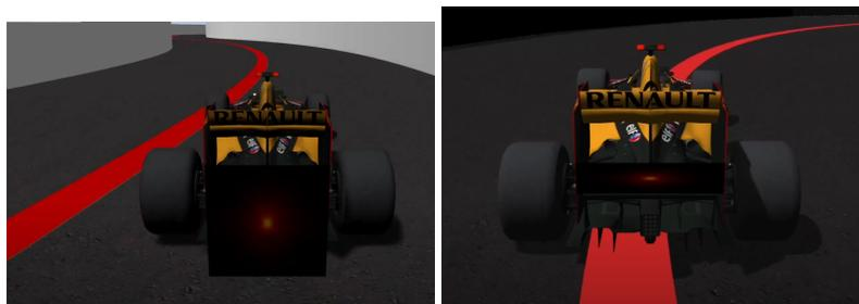
**Figura 4.15:** Imágenes de comparación entre ejecuciones del Sigue Línea holonómico (derecha) y Ackermann (izquierda) en una curva.
