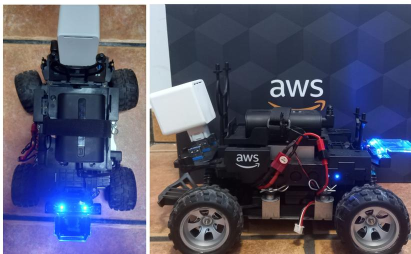
**Figura 5.8:** Coche robótico AWS DeepRacer, con geometría de Ackermann.
