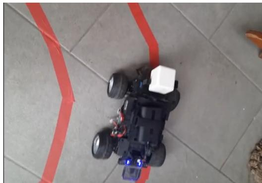
**Figura 5.15:** Imagen del AWS DeepRacer justo en el momento que empieza a recular para volver al carril.
