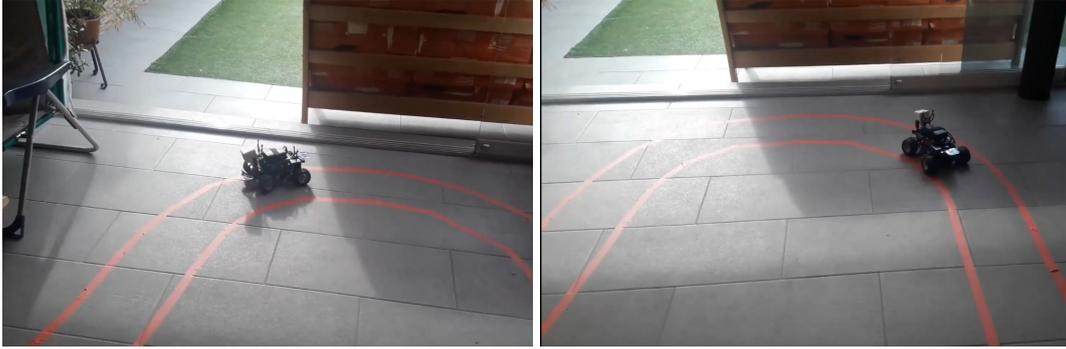
**Figura 5.13:** Imágenes del AWS DeepRacer tomando una curva con dos zonas, una con menos luminosidad (derecha), y otra con más (izquierda).
