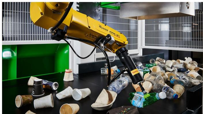
**Figura 1.1:** Brazo robótica en planta de reciclaje
