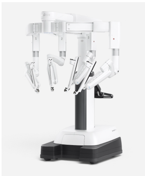
Figura 1.2: Robot quirúrgico Da Vinci de Intuitive Surgical [2].
