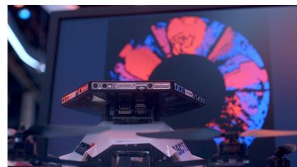
Figura 1.9: Intel Asctec Firefly: cámaras y detrás, mapa creado
