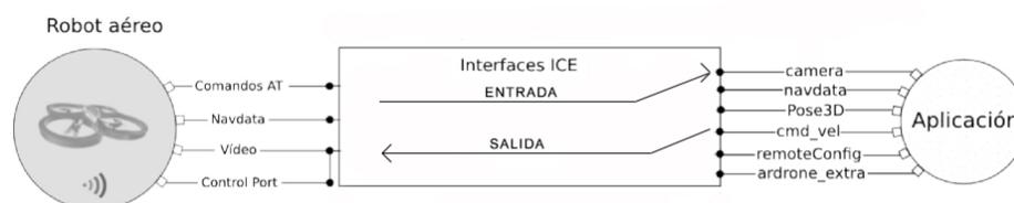
Figura 4.1: Diagrama de entradas y salidas del componente
