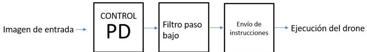
Figure 4.8: Esquema de control durante el algoritmo de búsqueda
