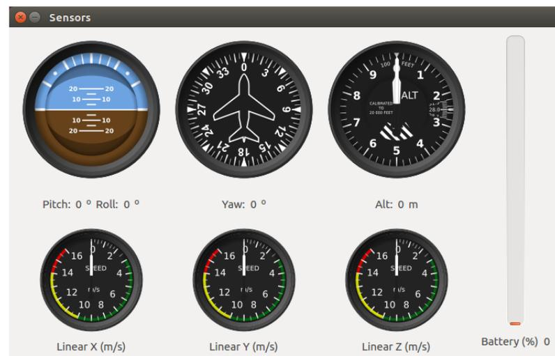
Figura 5.6: Interfaz gráfico de UAV-Viewer.py para mostrar los sensores
