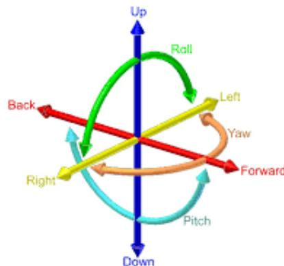
Figura 1.3: Diferentes movimientos que puede realizar un dron.
