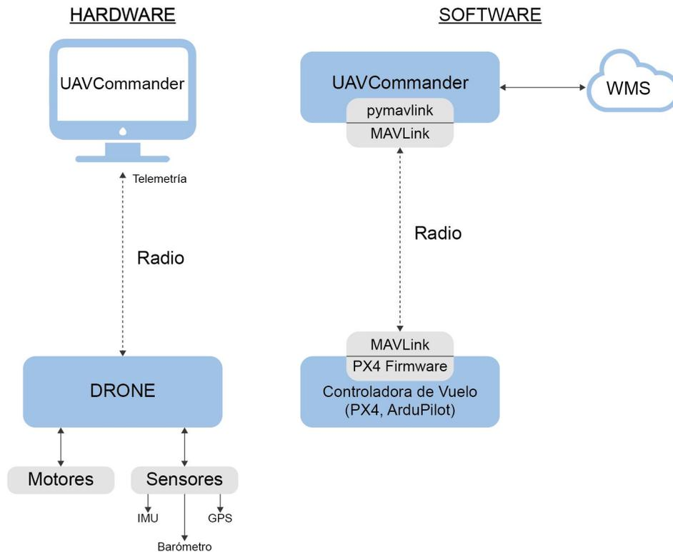
Figura 3.1: Esquema general del sistema.
