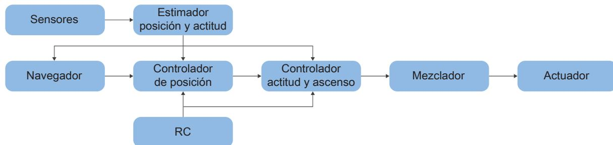
Figura 2.1: Bucle de control de un UAV [2].
