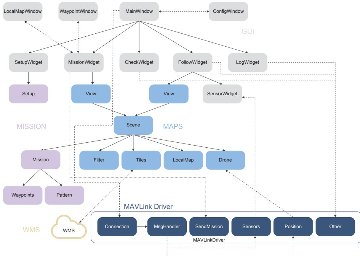
Figura 3.3: Esquema de clases del sistema.
