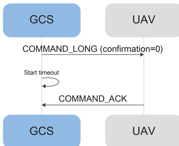
Figura 3.15: Diagrama del protocolo de comandos de MAVLink.
