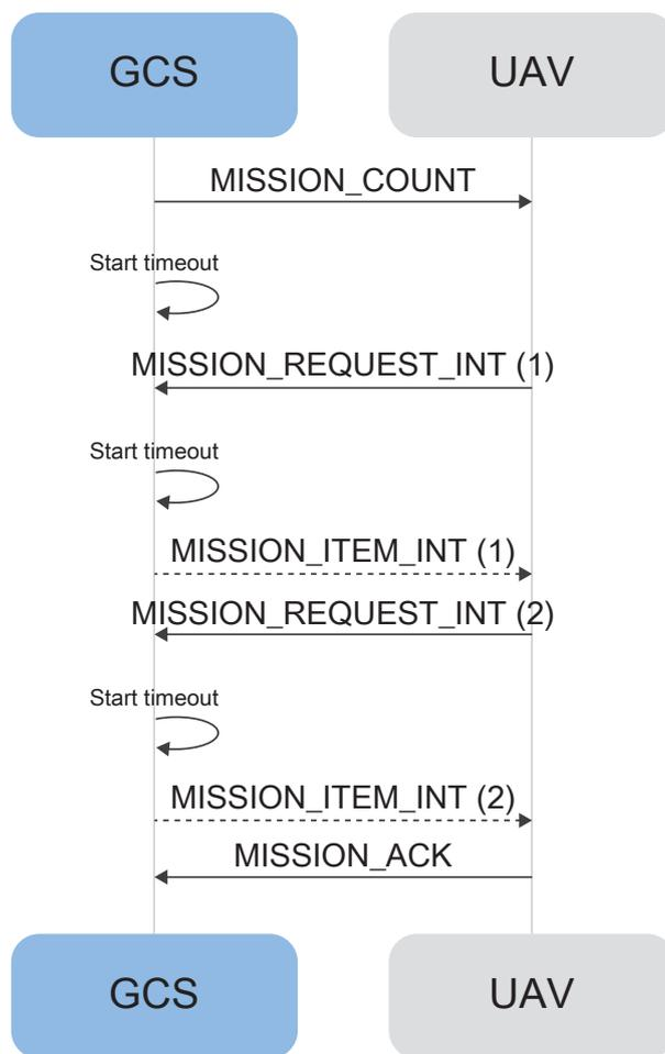
Figura 3.12: Diagrama del protocolo de misiones de MAVLink.
