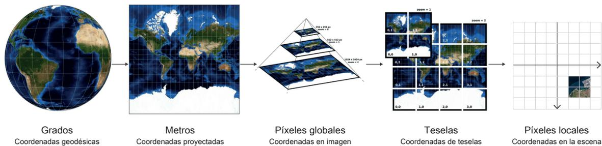
Figura 3.10: Esquema de conversión de coordenadas.
