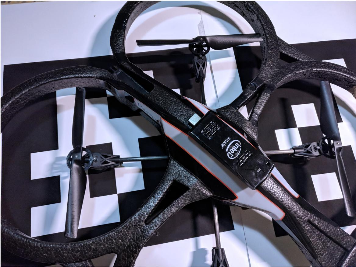
Figura 5.7: Intel Compute Stick acoplado en Ar.Drone 2.
