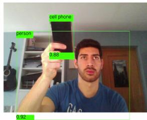
Figura 4.10: Aplicación web detección de objetos COCO-SSD
