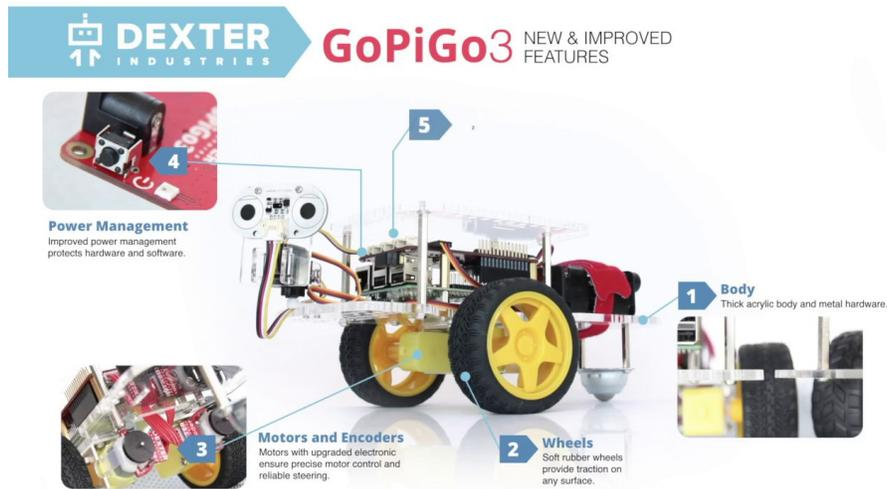
Figura 6.1: Diseño *hardware* del GoPiGo3
