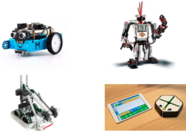
Figura 1.8: mBot (arriba izquierda), Mindstorms EV3 (arriba derecha), ejemplo de robot construido con VEX (abajo izquierda) y Root Robot (abajo derecha)
